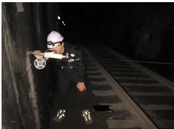
[해설 사진 2.2.50] 내공변위계 설치 전경 및 측정
